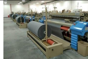
ETAPE 4 - TRANSFORMATION EN TISSU. Une fois teints (colorés), c'est en Pologne que les fils sont transformés en tissu . C'est l'étape de tissage .
