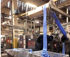
ETAPE 3 - TEINTURE DU FIL. Direction les Philippines : les fils y sont colorés avec de la teinture.
